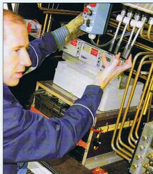
Centrale électrique: à gauche, la climatisation et, en dessous, la génératrice; à droite, l'unité de service hydraulique permettent de placer la semi de niveau.
