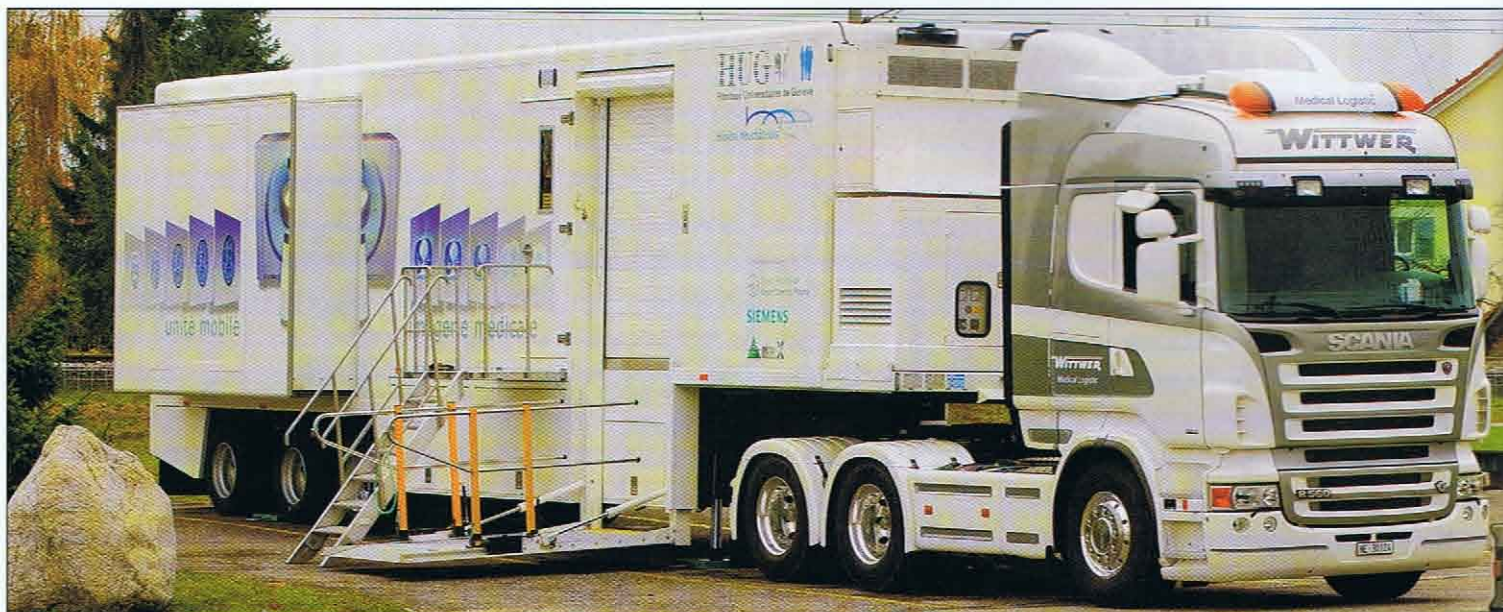
Le véhicule: combinaison de 50 tonnes unique en Suisse (pour l'instant), cet attelage abrite une unité complète de «Computertomographie» (scanner).
