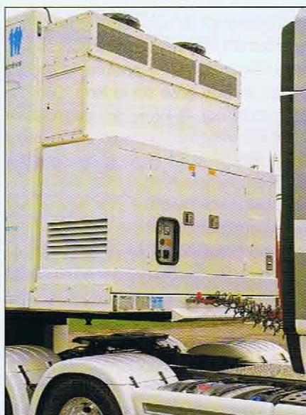
Centrale électrique: à gauche, la climatisation et, en dessous, la génératrice; à droite, l'unité de service hydraulique permettent de placer la semi de niveau.
